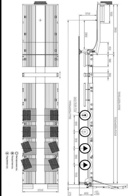
\* габаритными считается спецтехника или груз размером: ширина до 2505мм; высота до 3150мм; длина до 11240мм. Масса: 18475 кг.
